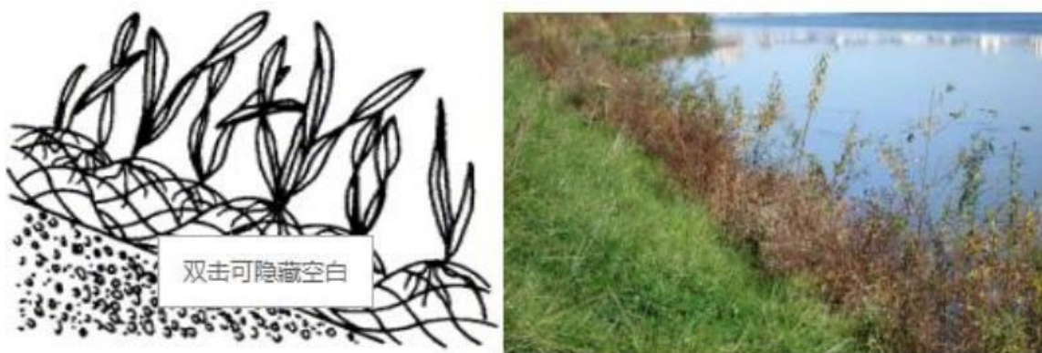
图 2.3-9 三维网垫植草护坡
